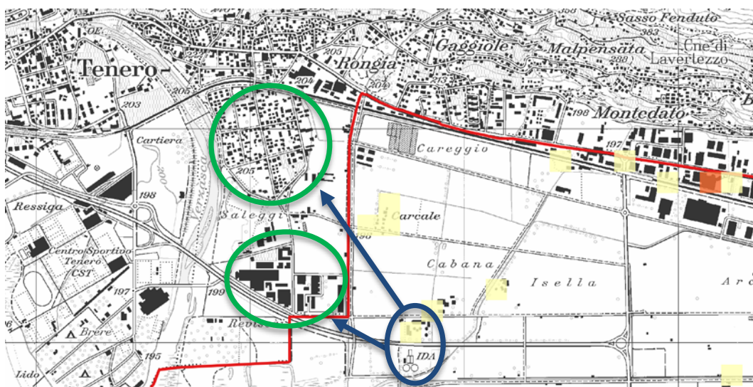
Figura 19 Possibile rete di teleriscaldamento futura da cogenerazione a biogas
